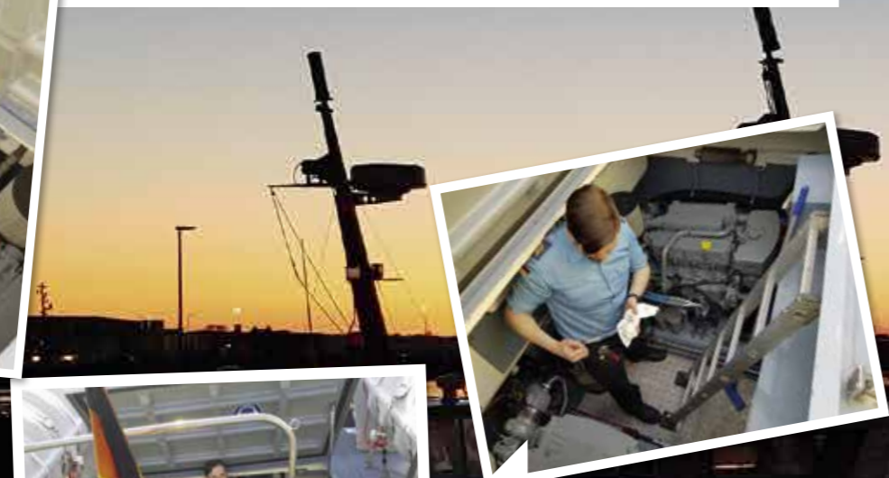
Vorm Ablegen prüfe ich Wasser, Öl, Luft, Kraftstoff, Elektrik („WOLKE-Prinzip“)
